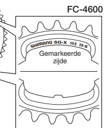
Zorg er voor dat de kleinste kettingring met de gemarkerde zijde naar achteren gericht is en breng de kettingring zodanig aan, dat het  $\triangle$  merkteken met de traparm uitgelijnd is.
