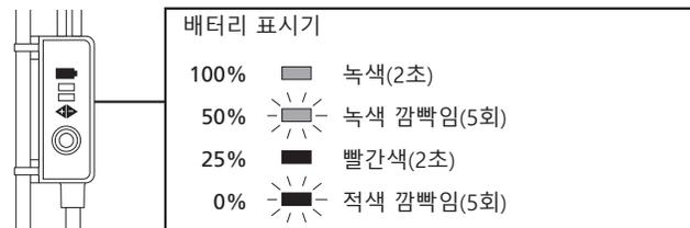
\* 배터리 잔량이 부족할 때 앞변속기가 먼저 작동을 멈춘 후 뒷변속기가 멈춥니다. 배터리가 완전히 방전되면, 변속기가 마지막 기어 위치에 고정됩니다. 배터리 표시기가 빨간색으로 켜지면 최대한 빨리 배터리를 충전할 것을 권장합니다.
