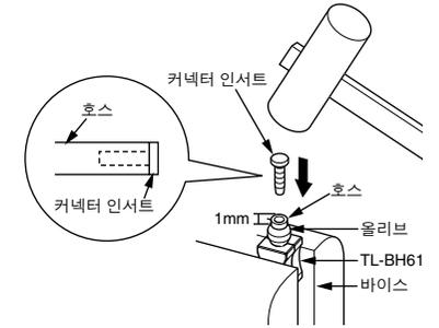
5. 올리브가 그림의 위치에 있는지 확인하고 커넥팅 볼트의 나사부에 그리스를 도포한 후에 브레이크 레버에 호스를 그림과 같이 장착합니다.
