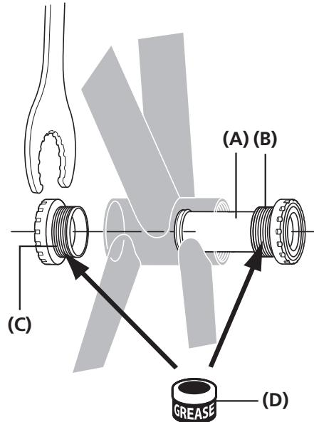
좌측 및 우측 어댑터에 그리스를 도포하고 SHIMANO 오리지널 툴을 사용하여 바텀 브래킷의 우측 어댑터와 이너 커버, 그리고 바텀 브래킷의 좌측 어댑터를 설치하십시오.
