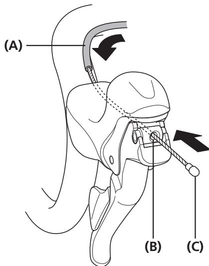
내부 케이블을 앞에서부터 곧장 통과시키고, 내부 케이블 드럼을 케이블 후크 안으로 놓은 다음, 반대쪽에서부터 외부 케이싱을 설치하십시오.
