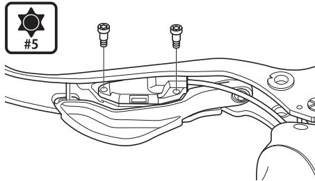
스위치 유닛을 스위치 유닛 고정판의 설치 위치로 되돌리고, 손으로 누르면서 변속 스위치 [X/Y]를 한번 더 작동하고 스위치가 켜졌는지 확인하십시오.
