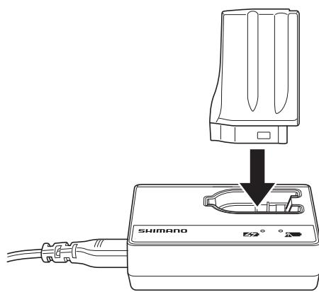
배터리(SM-BTR1)를 배터리 충전기(SM-BCR1)에 끝까지 삽입하십시오.
