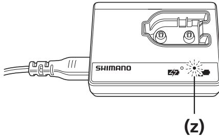
배터리 충전기에서 배터리를 제거하고 전기 콘센트에서 배터리의 전원 플러그를 분리한 후, 충전 작동을 반복하십시오.
