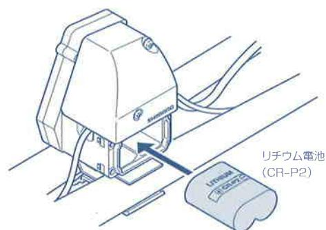
3. 電池を入れた後、バッテリーキャップを取り付け、バッテリーキャップ固定ボルトを確実に締付けてください。
