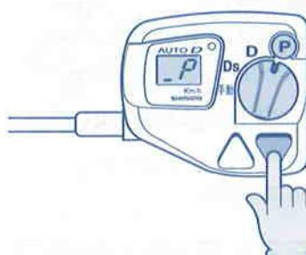
この状態でモードセレクトスイッチを他のモードに切替えると、モードセレクトスイッチを他のモードに切替えてもロックは解除されず、走行できません。
