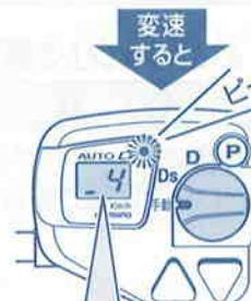
速度表示から変速位置を「-」と数字で表示します。また、LEDが赤く点灯し、「ピー」と音も鳴ります。
