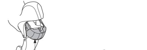
・図のようにインナーケーブルを通し、インナータイコをケーブル掛けにセットします。
