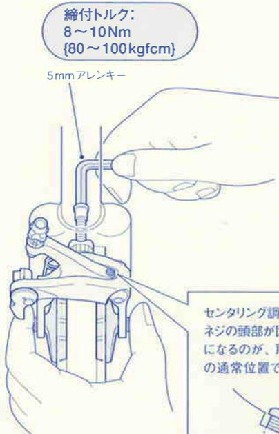
センタリング調整ネジは、ネジの頭部が図の位置になるのが、取付け時の通常位置です。
