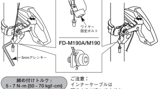
図のようにケーブルの初期の伸びをとった後、再びフロントディレイラーに固定しなおします。
