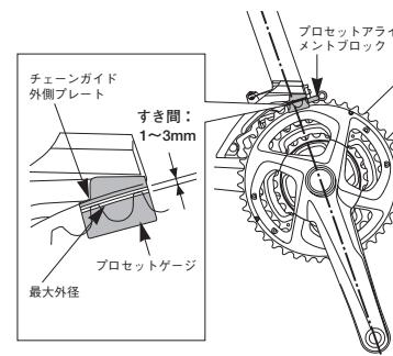
フロントディレイラーの高さをセットします。チェーンガイド外プレートの平らな部分が大ギアの真上の位置で大ギアと平行。5mmアレンキーを使用して固定します。
