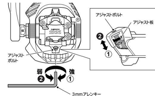
アジャストボルトを時計方向に回すとバネ力が強くなり、反時計方向に回すとバネ力が弱くなります。
