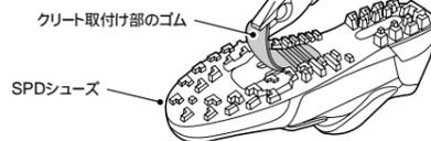
2. 中敷きを取外し、長穴に沿ってクリートナットをセットします。
