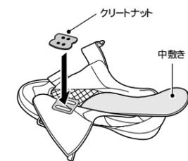
3. シューズの裏側から、クリート、クリートアダプターの順にセットし、クリート取付ボルトで締付け、仮止めします。クリートは左右共通です。
