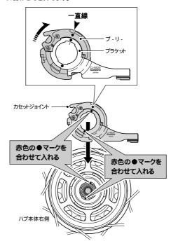
3. カセットジョイント固定リングで、カセットジョイントをハブ本体に 固定します。カセットジョイント固定リングの取付けは、黄色の ●マークをカセットジョイントのプーリーの黄色の ●マークに合 わせて入れ、カセットジョイント固定リングを45°時計方向に回
