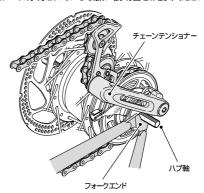
2. ハブ軸の右側と左側に回り止めワッシャーをセットします。この とき、フォークエンドの溝に、回り止めワッシャーの突起部が入 るように、カセットジョイントを回し、チェーンステーとはぼ平行に 取付けます。
