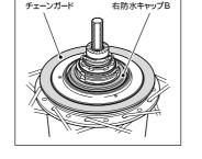
2. ガード板を外側にして、CS-S500スプロケットをハブ本体右側 の駆動体に取付け、スナップリングで固定します。
