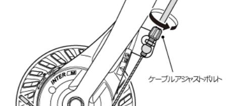
これでブレーキケーブルの取付けは完了です。取外しの際は、逆の手順で行ってください。なおスポークを交換の際は、必ずフィンを先に取外してください。
