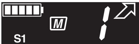
調整完了後、ボタンをシングルクリック (0.5秒) して、調整モードから変速モードへ変更してください。
