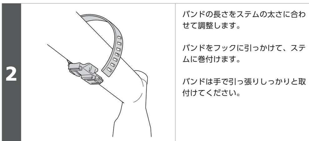
バンドの長さをステムの太さに合わせて調整します。
