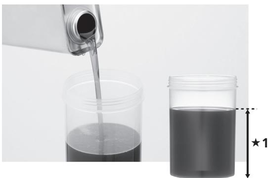
**2.** 図のように内部ユニットを左側からリングギアユニット1までオイルに浸します。
