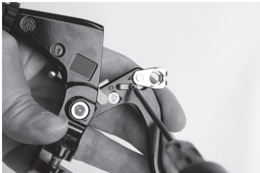
2. モード切替えを取付けるブレーキの位置に合わせます。
