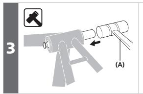
ボトムブラケットの先端が突き出る まで、プラスチックハンマーでシマ ノ専用工具を叩きます。 (A) プラスチックハンマー
