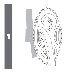
右クランクアームユニットをボトム ブラケットに当たるまで確実に挿入 します。
