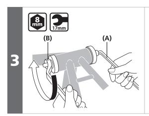
ボトムブラケットの当たり面がボトムブラケットシェルの当たり面に平行になっていることを確認し、ボトムブラケットをスパナで締付けて圧入します。
