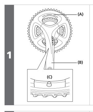
最大チェーンリングはマーキングの ある面が表側で、チェーン落ち防止 ピンの位置がクランクアームの裏側 にくるようにセットします。
