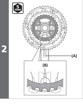
中間チェーンリングおよび最小 チェーンリングはマーキングのある 面が裏側で、位置決めの突起の位置 がクランクアームの裏側にくるよう にセットします。
