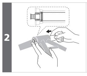
図のように指でフラップを押さえ、 反対側から押し込みます。 (押し込むとフラップが開きます。)
