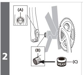
左クランクアームの幅広部と右クランクアームユニットの軸部の幅広部を合わせてセットします。
