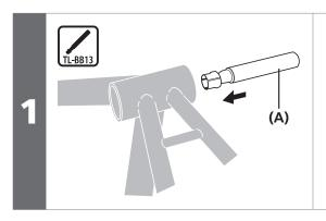
ボトムブラケットにシマノ専用工具 を挿入します。 (A) TL-BB13
