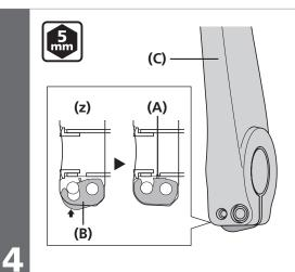
外れ止めプレートを押し込み、プレートピンが確実にセットされていることを確認し、左クランクアームのボルトを締付けます。
