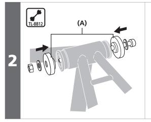
ボトムブラケットにシマノ専用工具 を挿入します。 **(A)** TL-BB12
