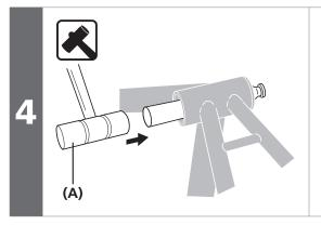
反対側のボトムブラケットも同じよ うに叩いて外します。 **(A)** プラスチックハンマー
