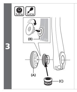
シマノ専用工具を使用して、キャップを締付けます。
