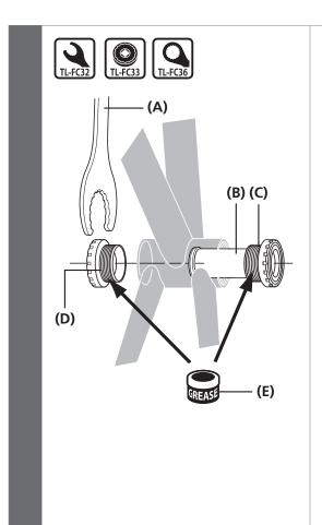
左右のアダプターにグリスを塗布 し、ボトムブラケットの右アダプ ター、インナーカバーおよびボトム ブラケットの左アダプターを、シマ ノ専用工具を使用して取付けます。
