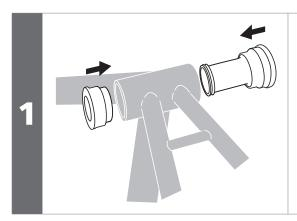
ボトムブラケットシェルにボトムブ ラケットを挿入します。
