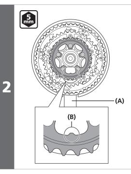
中間チェーンリングおよび最小 チェーンリングはマーキングのある 面が裏側で、位置決めの突起の位置 がクランクアームの裏側にくるよう にセットします。
