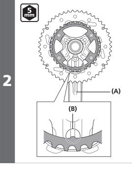
最小チェーンリングはマーキングの ある面が裏側で、位置決めの突起の 位置がクランクアームの裏側にくる ようにセットします。
