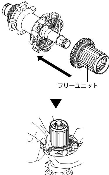
3. 右キャップとハブ軸のすき間にグリスを塗布し、右キャップを取り付けます。
