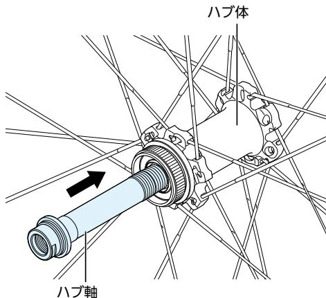
2. ハブ体にハブ軸を取付け後、軸ねじ部にグリスを塗布します。
