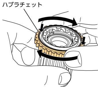
空転したときは、ハ布拉チエットを引き上げ時計方向に回して位置をリセットしてから、前の手順を繰り返します。何度か試しても空転する場合は、フリーユニットが故障しているおそれがあります。
