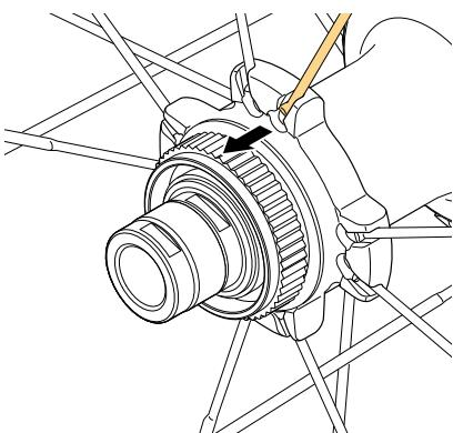
3. 図のように、ハブフランジの溝に新しいスポークを挿入します。
