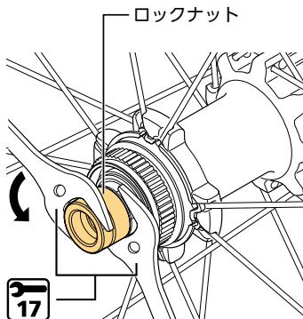
2. ロックナット、玉押し、シールリングを取外します。
