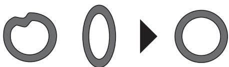
アウターケーシングを切断する時は、刻印の付いた端部の反対側の端部を切断します。
