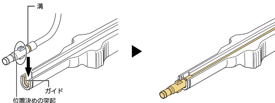
2. エレクトリックワイヤーのプラグを、E-TUBEポートに挿入します。
