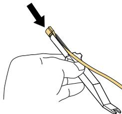
2. エレクトリックワイヤーのプラグを、E-TUBEポートに挿入します。
