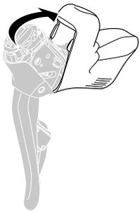
2. ドライバーを使用しバッテリーホルダーを開け、古いコイン電池の先端を押下げながら取出します。
