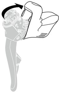
4. バッテリーホルダーを閉じ、ドライバーでしっかりと固定します。
