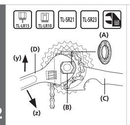
HGギアの取付けはシマノ専用工具 TL-LR15 / LR10でロックリングを 締付けます。
