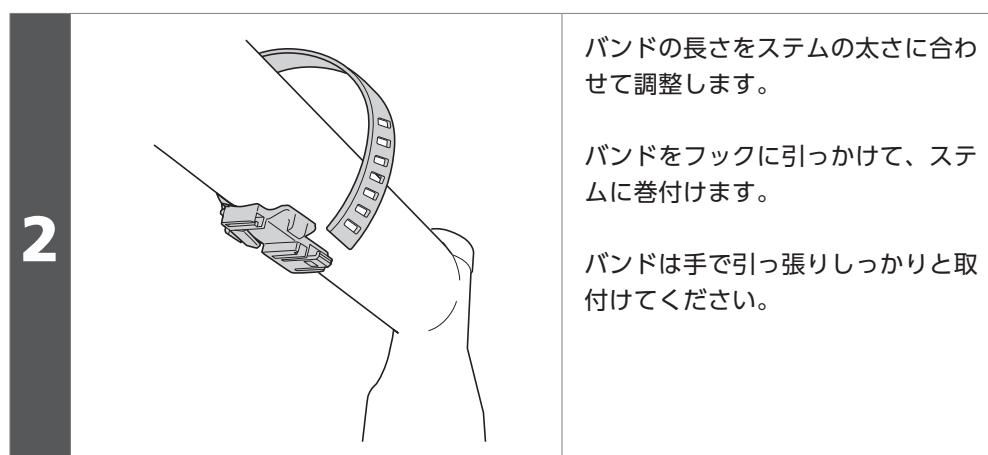
バンドの長さをシステムの太さに合わせて調整します。
