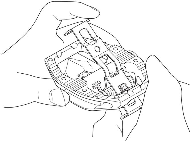
下側プレートのフック部を上側プレート中央の穴に掛け、上下2つのプレートを組み合わせます。
