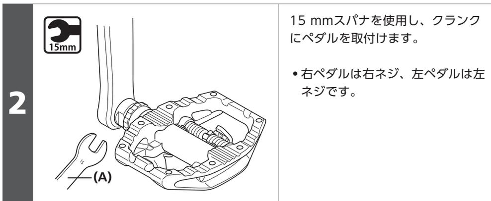
15 mmスパナを使用し、クランクにペダルを取付けます。
