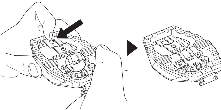
プレート取付けボルトで固定します。
