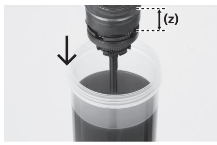
図のように内部ユニットを左側からリングギアユニット1までオイルに浸します。
