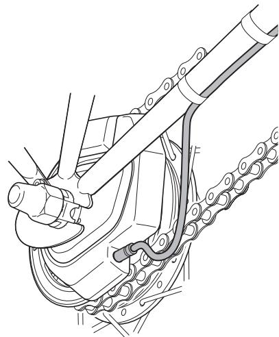
エレクトリックワイヤーをテープなどでフレームに沿わせて仮止めし、ジャンクション (B) へ接続します。
