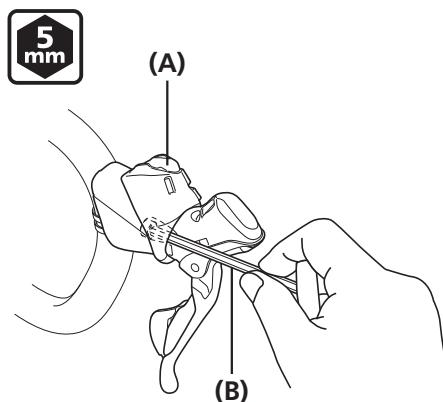
ブラケットカバーを前側からめくり、5 mm六角レンチで取付けナットを締付けて固定します。
