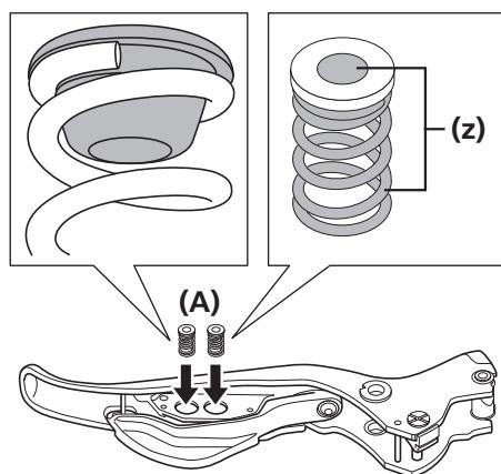
スプリングにボタンが付いていることを確認し、スイッチスプリングをスイッチユニット固定板の穴にセットします。
