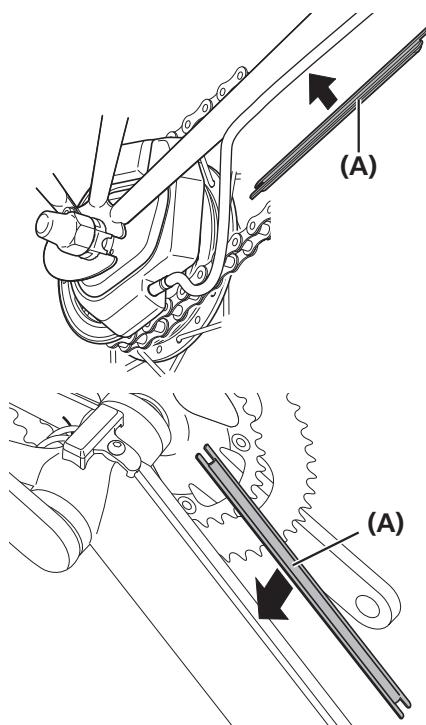
エレクトリックワイヤーカバー/コードカバーをフレームに取付けます。
