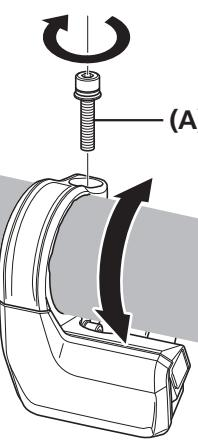
システムインフォメーションディスプレイを見やすい角度に調整し、3mm六角レンチでクランプボルトを締付けてください。
