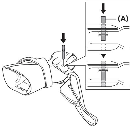
軸穴を一致させ、レバー軸を圧入します。
