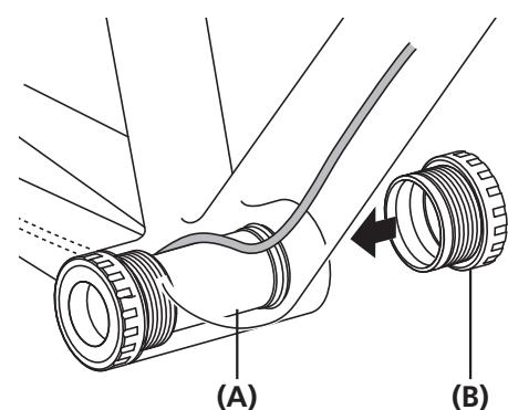
ハンガーにインナーカバーを取付ける際、モーターユニット、内蔵バッテリー用のエレクトリックワイヤーはインナーカバーの上を通すようにしてください。
