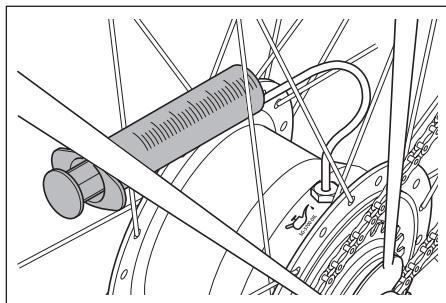
注射器をスポークの間に入れ、オイルポートが、下を向く位置までホイールを正転方向にゆっくり回転させます。
