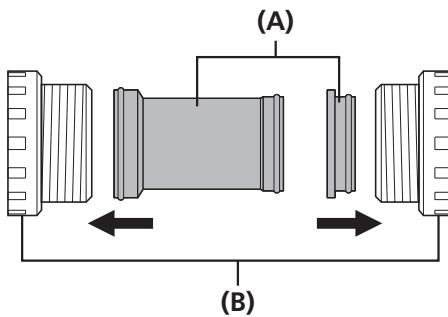
ボトムブラケットのアダプターにインナーカバーを取付けます。
