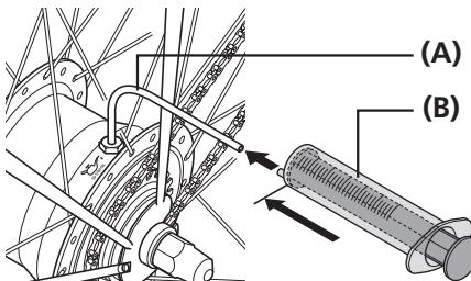
注射器のピストンを奥まで押し込んだ状態で、チューブに注射器をしっかりと接続します。
