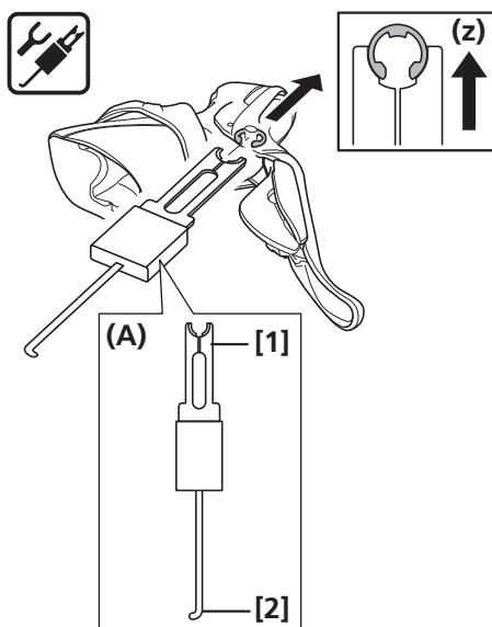
別売のシマノ専用工具を使用してスナップリングを取り外します。
