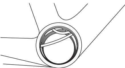
モーターユニット、内蔵バッテリー用のエレクトリックワイヤーだけがハンガー内部に見えるようにし、ワイヤーホルダーなど不要なものが出ていればフレームの中に押し込んでください。
