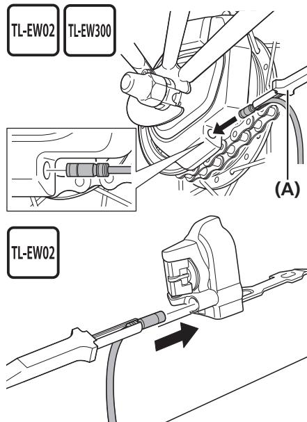
モータユニット、バッテリーマウントにエレクトリックワイヤーを接続します。
