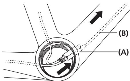
システムインフォメーションディスプレイ用のエレクトリックワイヤーとジャンクション (B) をダウンチューブに内蔵します。
