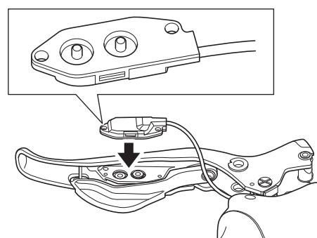
スイッチユニットをスイッチユニット固定板の取付け面に当ててください。
