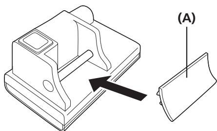
システムインフォメーションディスプレイにゴム間座を取付けます。
