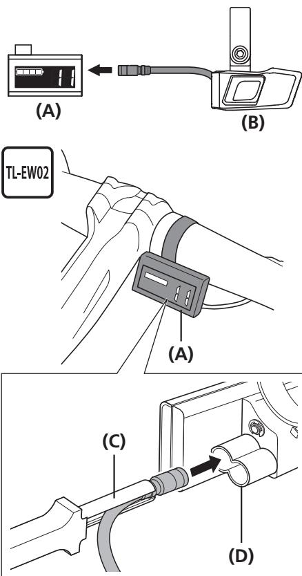
シフトスイッチのエレクトリックワイヤーをTL-EW02を使用して、システムインフォメーションディスプレイ (SC-S705) に接続します。
