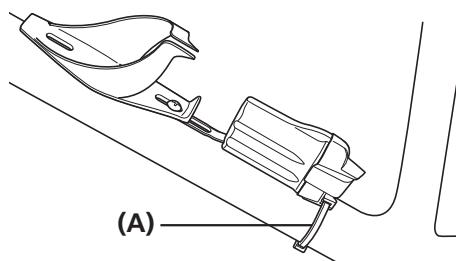
ボトルケージのボルトを締付け固定します。
