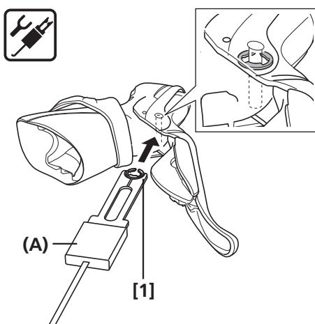
シマノ専用工具の[1]部分を使用してスナップリングをはめ込みます。
