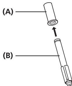
シートポスト底部からシートポストカラー内に内蔵バッテリーを挿入します。
