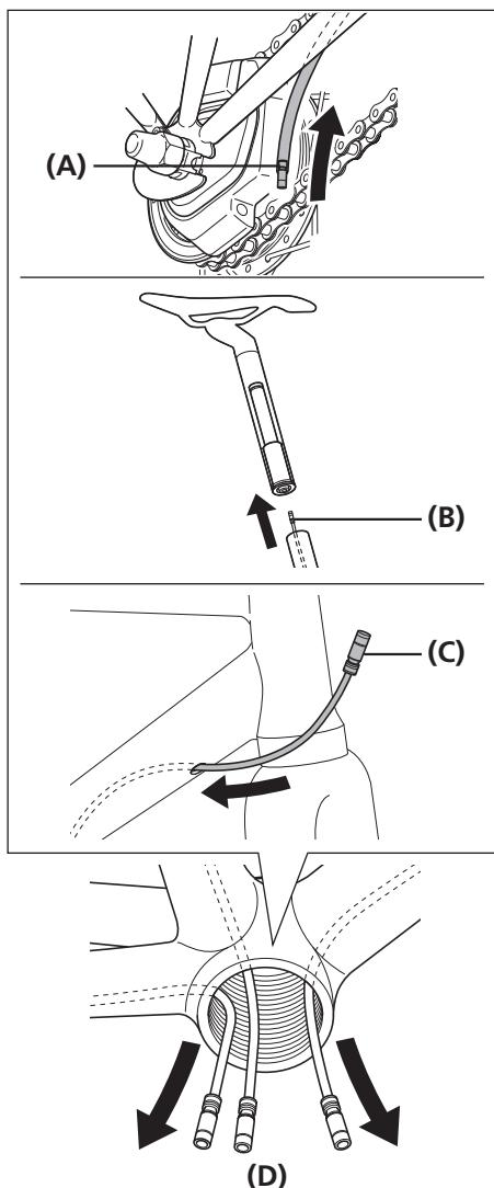
最初にSC-S705、バッテリーマウント、モーターユニット各部のエレクトリックワイヤーをフレームの穴からハンガー部に通します。
