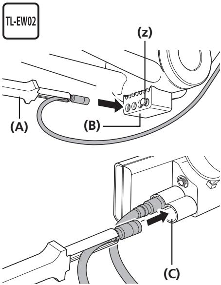
SC-S705のE-TUBEポートとジャンクション(B)にエレクトリックワイヤーを接続します。
