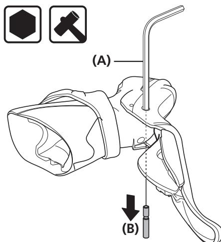
六角レンチなどを使用してレバー軸の穴に差込み、プラスチックハンマーで少しづつ叩きレバー軸を抜き出します。
