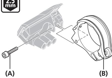
2.5 mm六角レンチでケース固定ボルトを取り外し、クランプバンドを交換します。
