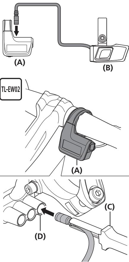
シフトスイッチのエレクトリックワイヤーをTL-EW02を使用して、システムインフォメーションディスプレイ (SC-MT800) に接続します。
