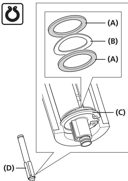
バッテリーアダプターの溝にワッシャー、ウェーブワッシャー、ワッシャーを取り付け、スナップリングで固定します。
