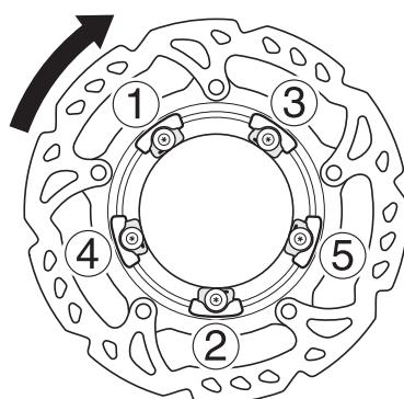
手袋を着用して、ディスクブレーキローターに力をかけて時計方向に回します。
