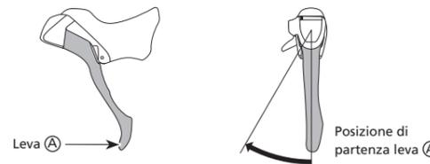
Spingere in su la leva del blocco e poi rilasciarla. Se il cambio non funziona, spingere di nuovo la leva fino al blocco.
