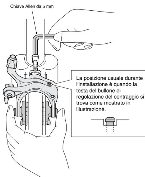
La posizione usuale durante l'installazione è quando la testa del bullone di regolazione del centraggio si trova come mostrato in illustrazione.
