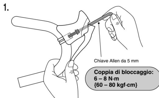
Quando si installano i componenti sulle superfici del manubrio/telaio in carbonio, verificare con il produttore delle parti/telaio in carbonio i livelli raccomandati per la coppia di serraggio, in modo da prevenire un eccessivo serraggio che potrebbe danneggiare il materiale in carbonio e/o un serraggio insufficiente che potrebbe determinare un fissaggio inadeguato dei componenti.
