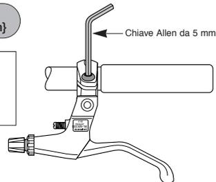
Quando si installano i componenti sulle superfici del manubrio/telaio in carbonio, verificare con il produttore delle parti/telaio in carbonio i livelli raccomandati per la coppia di serraggio, in modo da prevenire un eccessivo serraggio che potrebbe danneggiare il materiale in carbonio e/o un serraggio insufficiente che potrebbe determinare un fissaggio inadeguato dei componenti.
