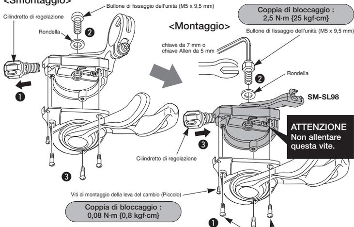
Allentare il bullone di fissaggio del cavo (dado) del deragliatore anteriore, quindi tirare il cavo interno fuori dall'unità leva del cambio allo stesso modo in cui è stato installato il cavo interno.
