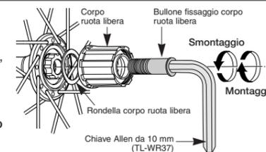
Nota: Non provare a smontare il corpo ruota libera perché potrebbe portare a malfunzionamenti.
