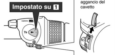
2. Girare il coperchio di regolazione del cavetto in modo che il bullone di regolazione del cavetto sporga di circa 7 - 8 mm. Dopodiché, svitare la vite di fissaggio della copertura e quindi rimuovere la copertura dell'indicatore.
