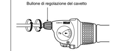
2. Terminata la regolazione del giunto a cassetta, tagliare via la lunghezza in eccesso del cavetto interno, quindi installare il cappuccetto interno terminale.
