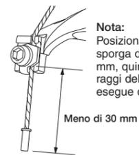
**Nota:** Posizionare il cavetto interno in modo che sporga di una lunghezza inferiore a circa 30 mm, quindi controllare che non interferisca con i raggi della ruota. Bloccare la ruota mentre si esegue questa operazione.
