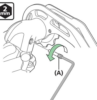
Per rimuovere l'asse di fissaggio, usare una brugola da 2 mm.
