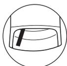
**3.** Installare l'indicatore agganciando prima il dente d'arresto, quindi fissarlo stringendo le due viti di fissaggio dell'indicatore. Cacciavite N.ro 2
