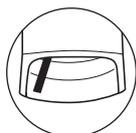
**3.** Installare l'indicatore agganciando prima il dente d'arresto, quindi fissarlo stringendo le quattro viti di fissaggio dell'indicatore.
