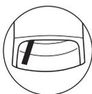
3. Installare l'indicatore agganciando prima il dente d'arresto, quindi fissarlo stringendo le tre viti di fissaggio dell'indicatore. Cacciavite N.ro 2
