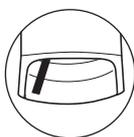
**3.** Installare l'indicatore agganciando prima il dente d'arresto, quindi fissarlo stringendo le due viti di fissaggio dell'indicatore.
