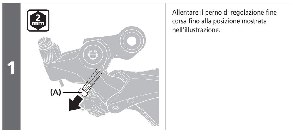
Allentare il perno di regolazione fine corsa fino alla posizione mostrata nell'illustrazione.
