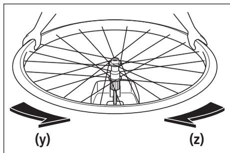
Dopo aver estratto il mozzo rimuovere il bullone di fissaggio della ruota libera (all'interno del corpo della ruota libera), quindi sostituire il corpo della ruota libera.
