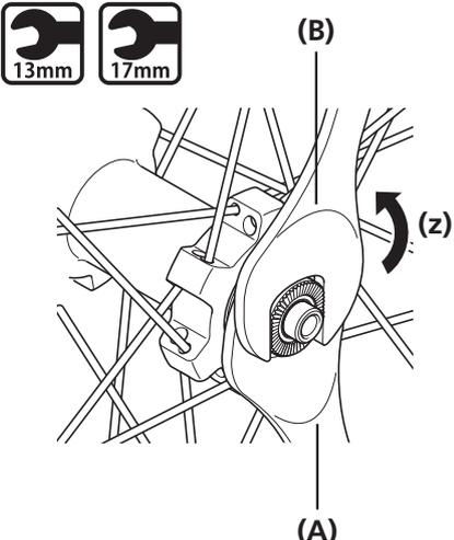
Usare la chiave per allentare il dado di fissaggio sulla sezione doppio bloccaggio.
