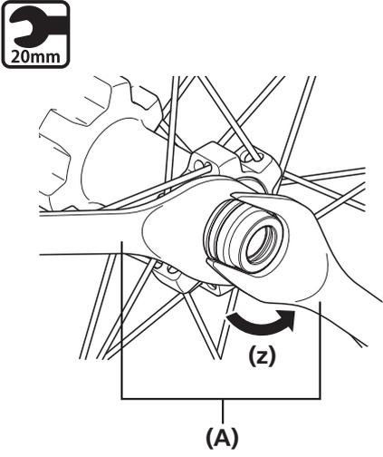
Usare la chiave per allentare il dado di fissaggio sulla sezione doppio bloccaggio.
