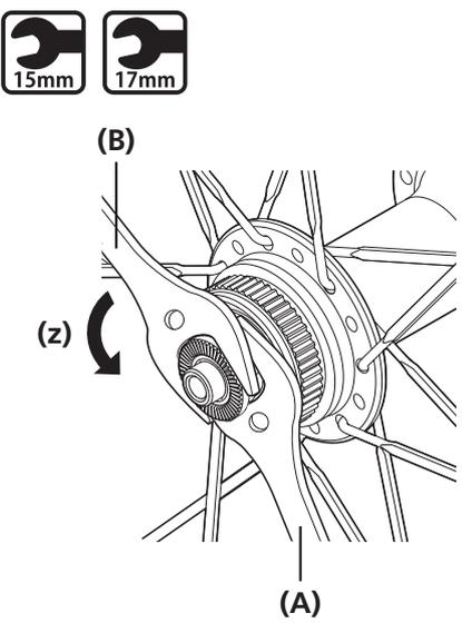
Usare la chiave per allentare il dado di fissaggio sulla sezione doppio bloccaggio.
