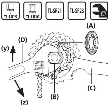
Per l'installazione dei pignoni HG, utilizzare l'utensile originale Shimano TL-LR15/LR10 per stringere l'anello di bloccaggio.
