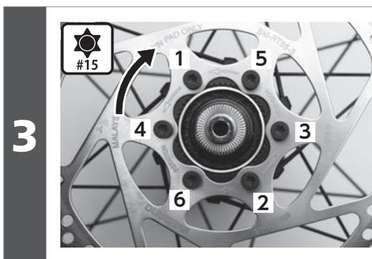
Indossare i guanti e ruotare il rotore del freno a disco in senso orario con una certa forza.
