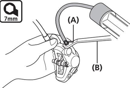
Posizionare una chiave a bussola da 7 mm, riempire la siringa d'olio, collegare un tubo al nipplo di spurgo e quindi allentare il nipplo di spurgo di 1/8 di giro per aprirlo.
