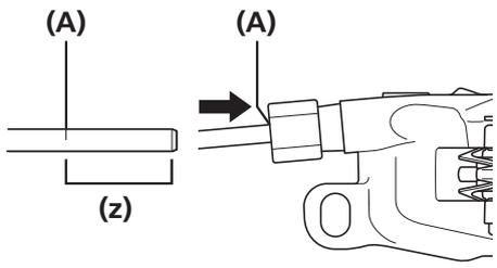
Per verificare che le estremità del tubo freni siano saldamente inserite nella base dei punti di fissaggio del tubo freni sulle pinze e sul comando freno, contrassegnare preventivamente il tubo freni come mostrato nell'illustrazione.
