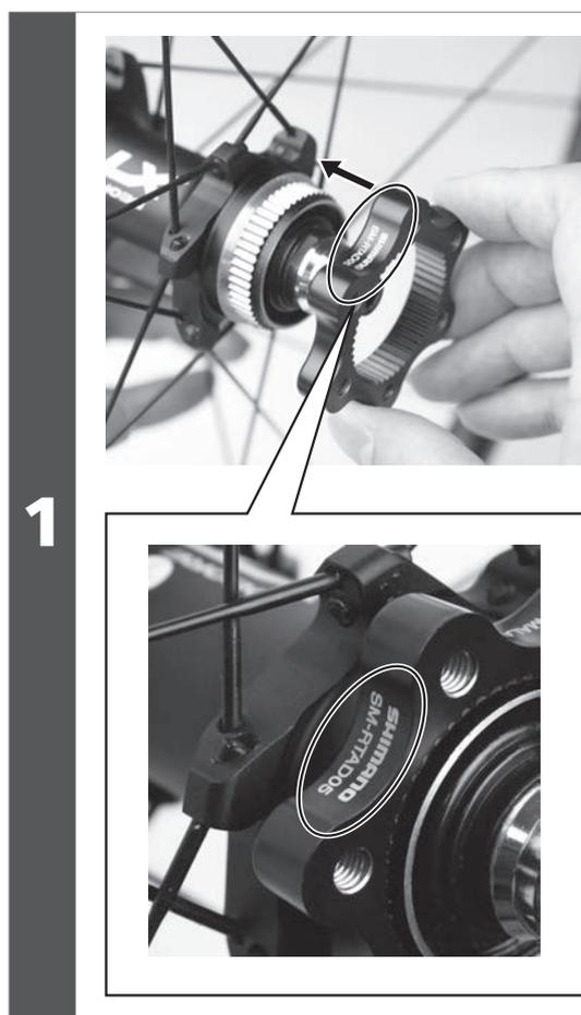
Posizionare l'adattatore del rotore sul mozzo.
