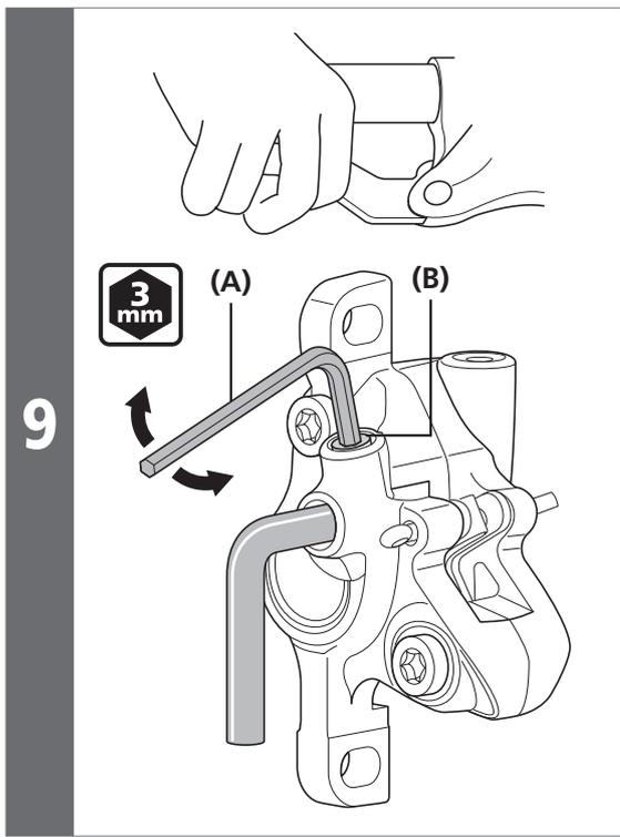
Tenendo azionata la leva freno, aprire e chiudere la vite di spurgo in rapida successione (circa 0,5 secondi per volta) per eliminare eventuali bolle d'aria ancora presenti nelle pinze freno.
