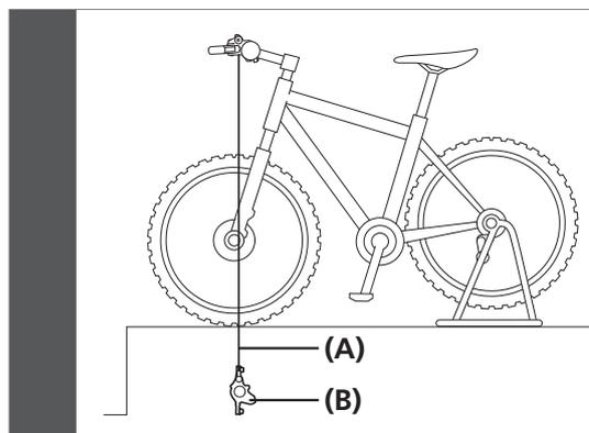
Con la rondella di spurgo (giallo) ancora fissata alle pinze, posizionare la bicicletta su un cavalletto o supporto analogo come mostrato nell'illustrazione.
