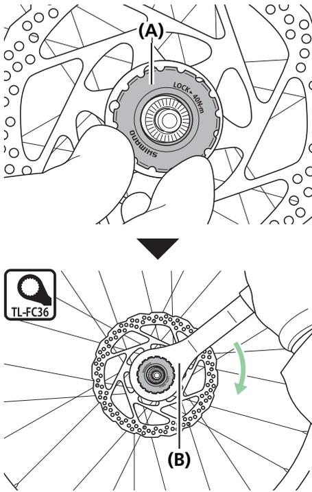
Stringere la ghiera di bloccaggio per il rotore del freno a disco.
