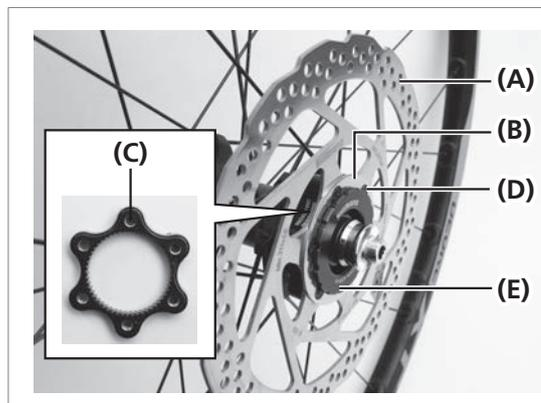
Da utilizzare per installare un rotore per freno a disco a 6 perni su un mozzo/ruota sistema center lock.
