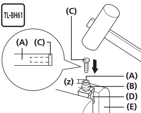
Usare un utensile smussato per rendere uniforme l'interno dell'estremità tagliata del tubo freni, quindi montare l'inserto connettore.
