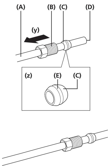
Far passare il tubo freni attraverso il perno di connessione e l'oliva, come mostrato nell'illustrazione.
