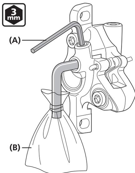
Fissare il tubo e la sacca in dotazione con elastici, posizionare una brugola da 3 mm come mostrato nell'illustrazione e collegare il tubo al perno di spurgo.
