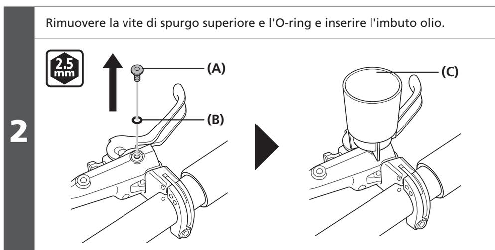
Rimuovere la vite di spurgo superiore e l'O-ring e inserire l'imbuto olio.
