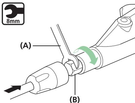
Spingendo il tubo freni, serrare il perno di connessione.
