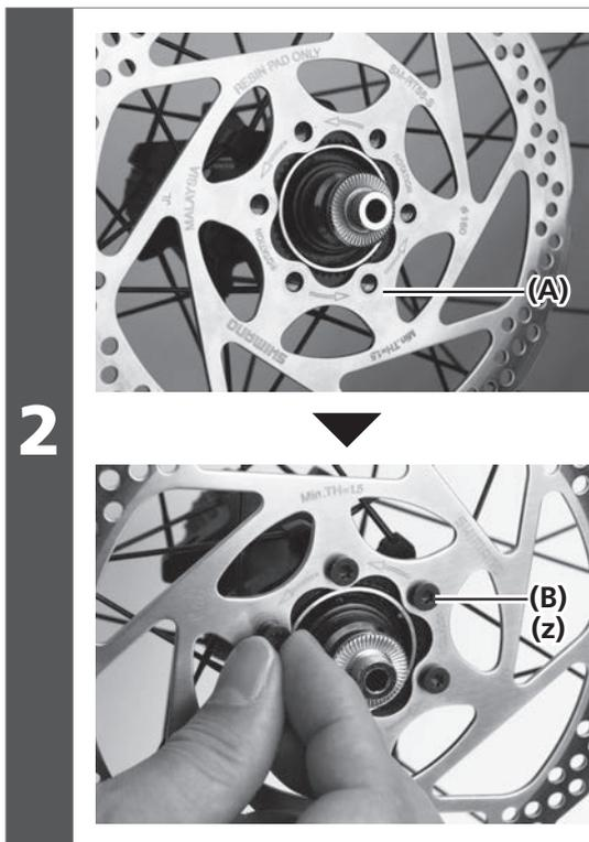
Posizionare il rotore del freno a disco sul mozzo, quindi fissarlo provvisoriamente serrando i perni di fissaggio del rotore del freno a disco.
