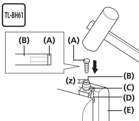
Usare un utensile smussato per rendere uniforme l'interno dell'estremità tagliata del tubo freni, quindi montare l'inserto connettore.
