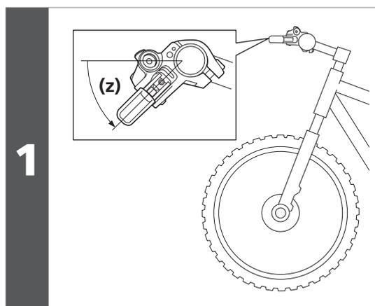
Posizionare il comando freno in modo che formi un angolo di 45° con il terreno, in assetto di marcia.
