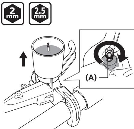
Togliere l'imbuto mentre è ancora chiuso con il tappo, quindi fissare l'O-ring alla vite di spurgo e serrarla lasciando fuoriuscire l'olio, in modo da garantire che non vi siano bolle d'aria residue all'interno del serbatoio.
