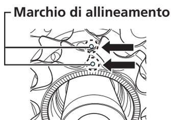
3. Collocare l'anello di bloccaggio nel corpo mozzo posteriore e utilizzare un utensile originale SHIMANO per stringere.
