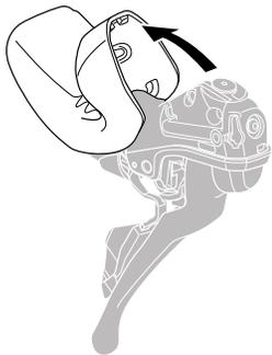
6. Posizionare la leva in modo che la superficie superiore della vite di spurgo risulti parallela al terreno.
