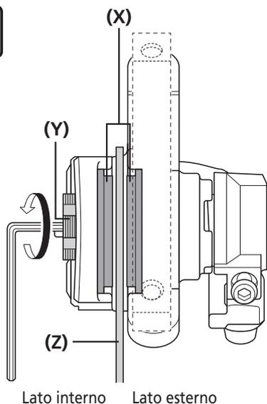
Allentare di uno o due scatti la vite di regolazione delle pastiglie, ruotandola in senso antiorario.
