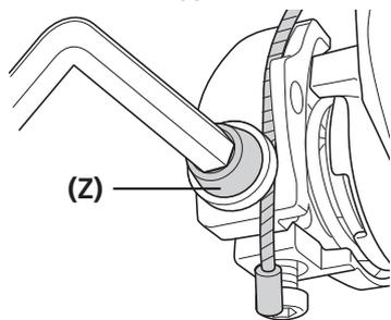
Allentare il perno di fissaggio del cavo, tendere il cavo, quindi stringere nuovamente il perno di fissaggio del cavo.
