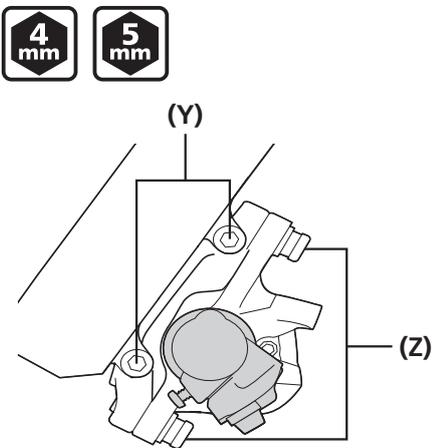
Stringere i perni di fissaggio della pinza freno A.
