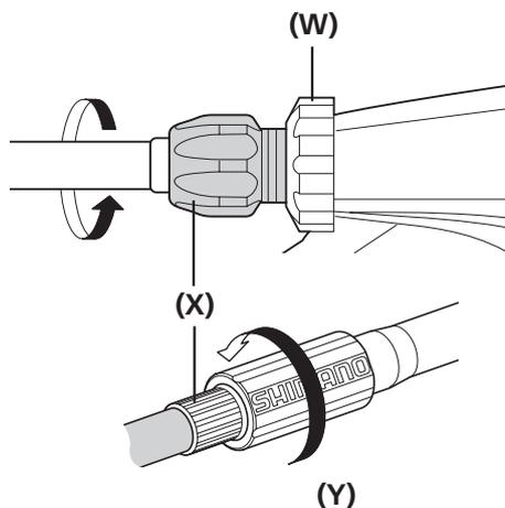
Ruotare il registro cavo a barilotto in senso antiorario per regolare la tensione del cavo, quindi stringere a mano il dado di regolazione del cavo, se presente.
