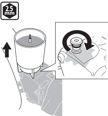
Togliere l'imbuto mentre è ancora chiuso con il tappo, quindi fissare l'O-ring alla vite di spurgo e stringerla fino alla fuoriuscita dell'olio, per garantire che non vi siano bolle d'aria residue all'interno del serbatoio.
