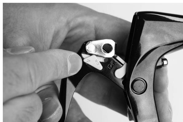
**2.** Allineare il selettore di modalità alla posizione del freno installato.
