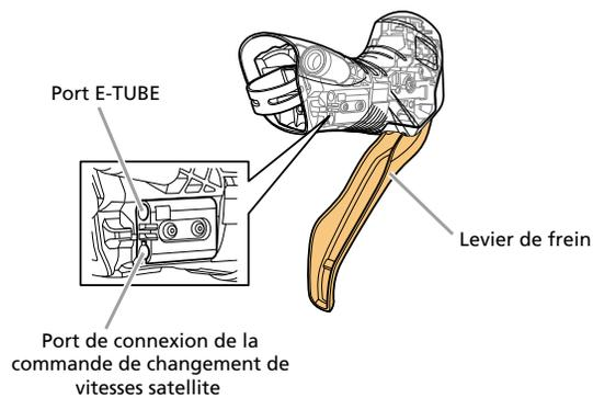
\* Le port E-TUBE et le port de connexion de la commande de changement de vitesses satellite ne peuvent pas être utilisés. Il n'est pas possible d'installer une fiche sans résistance de charge.
