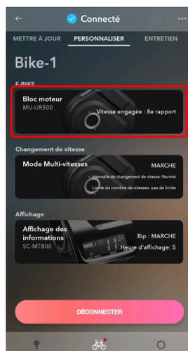
2. Sélectionnez le nombre de vitesses du moyeu à vitesses internes sur lequel l'unité motrice est montée.
