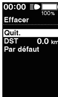
2. Pour réinitialiser la distance parcourue, sélectionnez [OK] à l'aide du bouton Assistance-X ou Assistance-Y et appuyez sur le bouton de fonction pour confirmer. Une fois la distance réinitialisée, l'écran revient automatiquement à la liste des menus.
