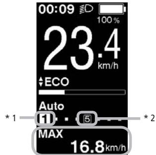
\*1 Vitesse engagée (s'affiche uniquement lorsque le système de changement de vitesse électronique est utilisé)
