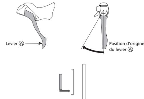
Poussez le levier vers le haut jusqu'à la butée et relâchez-le. Si le changement de vitesses ne s'effectue pas, poussez le levier à nouveau jusqu'à la butée.
