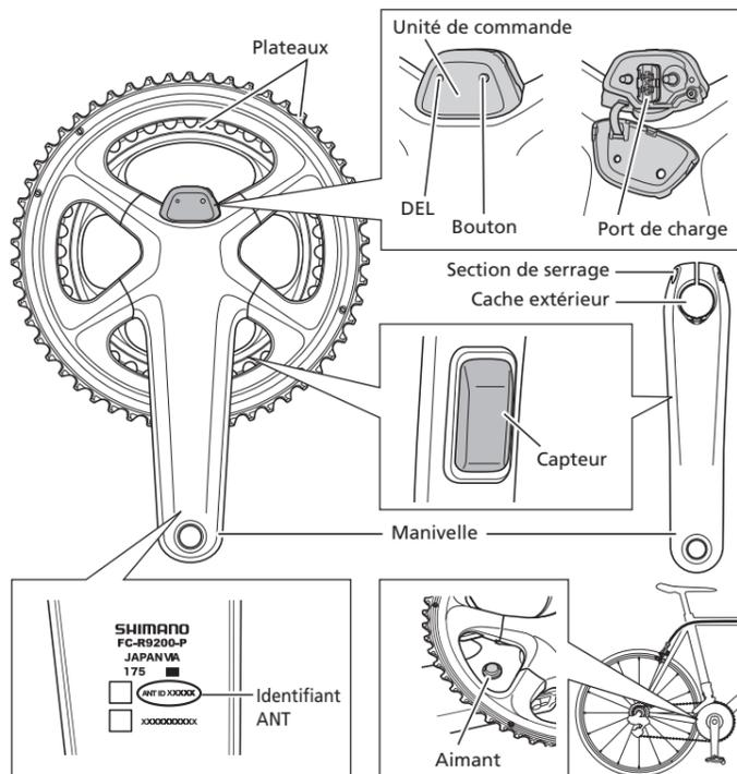
\* La position de l'unité de commande et la forme du port de connexion du câble de charge peuvent différer en fonction du modèle.
